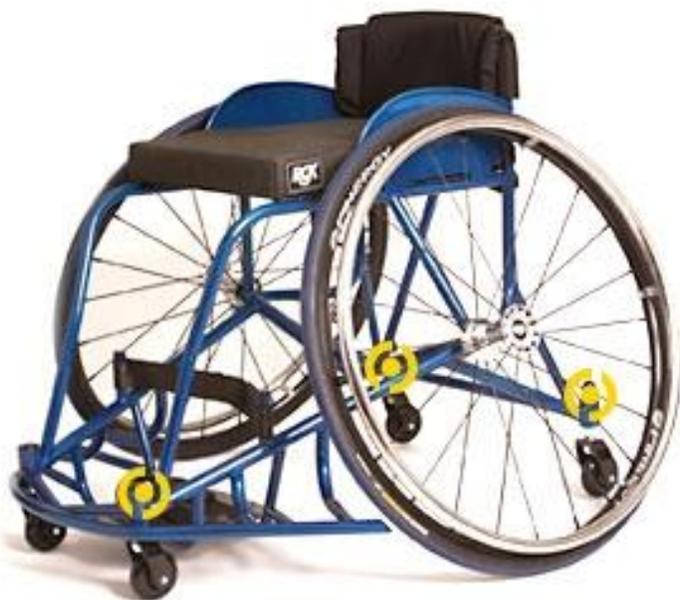
l'asse delle ruote, non parallela al suolo, bensì con un'angolazione variabile da 12 a 20 gradi.
